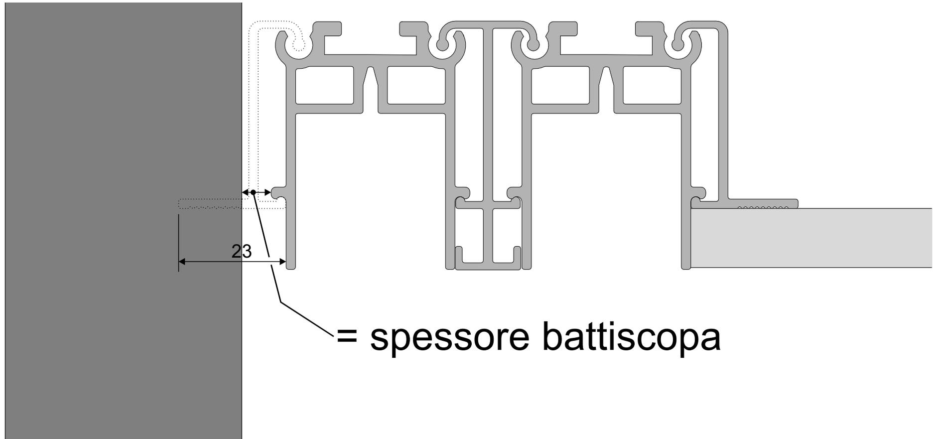
fissaggio binario nel controbinario a raso già installato
